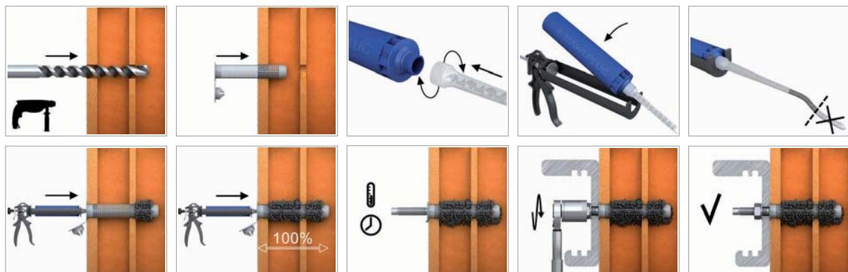
1. Просверлить отверстие необходимой длины и диаметра.
