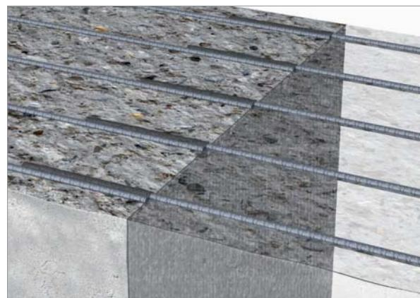
Рисунок 1.2 – Соединение внахлест
