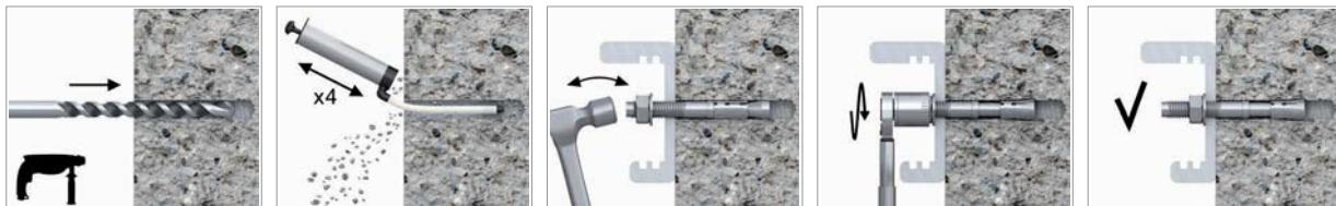
1. Просверлить отверстие необходимого диаметра и глубины
