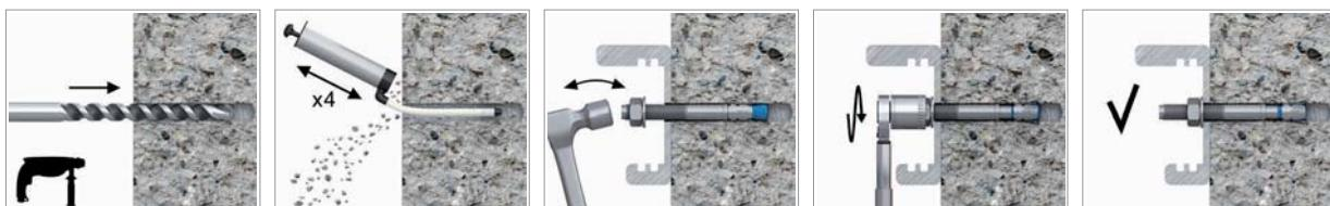
1. Просверлить отверстие необходимого диаметра и глубины
